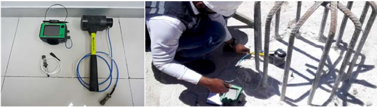
Figura 3. Equipo de pruebas de integridad, acelerómetro, martillo y colector de datos.
