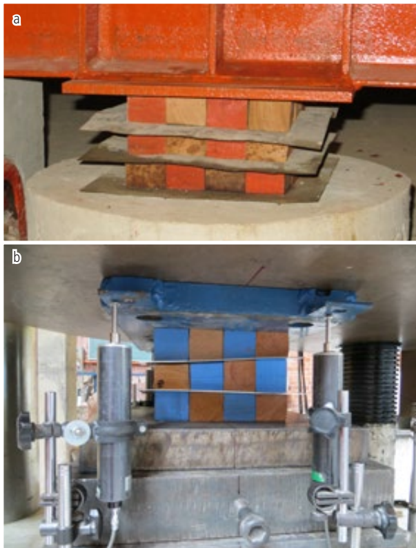
Figura 8. Celda de deformación con cubos húmedos y láminas deformadas: a) in situ , b) en laboratorio.
