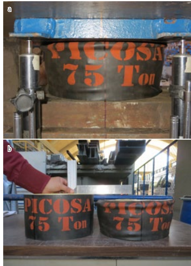
Figura 21. Cilindro polimérico: a) deformado, b) comparación de cilindros antes y después del ensayo.
